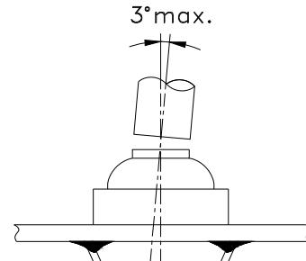
(7) 请避免从横侧、斜向的操作及只按开关操作部一侧的用法；如此可能会导致开关触感不良及耐久性的降低。
